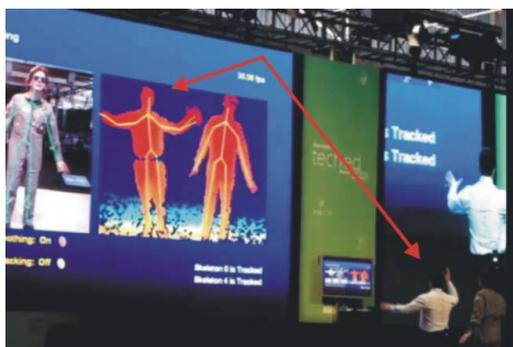
Imagem3: A câmera mapeia o corpo do jogador e forma um esqueleto de base (KINECT, 2010).
