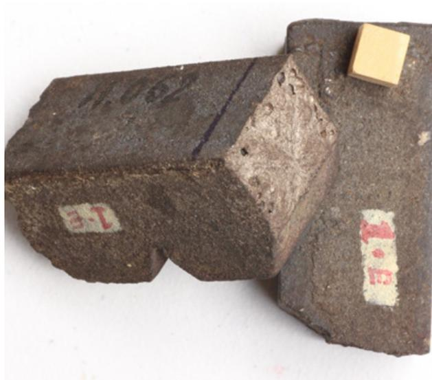
Figura 9 Lingote de gusa branco da coleção do Museu Nacional, mostrando a cor branca da fratura e a presença de porosidade no interior do material. Imagem do autor.
